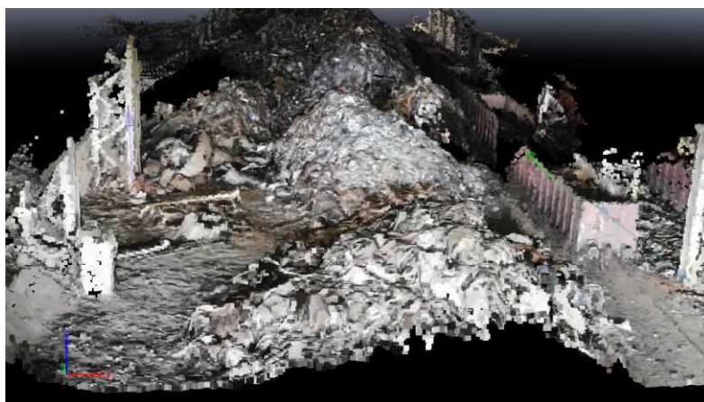
Фиг. 4: 3D модел на поле от закрит склад за скрап в „Стомана Индъстри“ АД, гр. Перник, получен при обработка на кадри от видео запис с камера на смартфон
