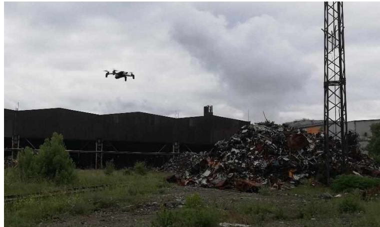
Фиг. 1: Координиране на наземни контролни точки и извършване на въздушно фотограметрично заснемане на открит склад за скрап в „Стомана Индъстри“ АД, гр. Перник
