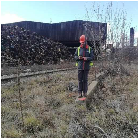
Фиг. 1: Координиране на наземни контролни точки и извършване на въздушно фотограметрично заснемане на открит склад за скрап в „Стомана Индъстри“ АД, гр. Перник
